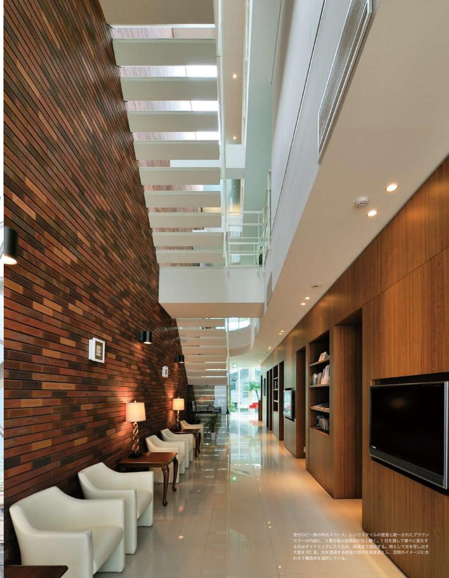
受付ロビー奥の待合スペース。レンガスタイルの壁面と統一されたブラウンカラーの内装に、3層を結ぶ階段が白く輝く。1日を通して様々に変化する光はダイナミックに入り込み、床面まで演出する。時として光を写し出す大壁をRC造、光を透過する吹抜け部分を鉄骨造とし、空間のイメージに合わせて構造体を選択している。
